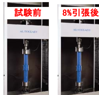
参考: 管の引張試験 8%の延伸では白化は見られない
