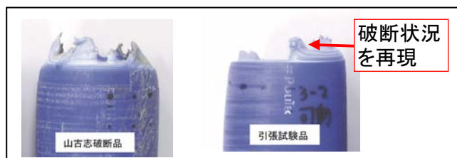
山古志破断品 図1の引張試験(87cm/秒)
