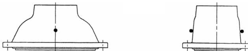
図 2 - 外面塗装の検査箇所
