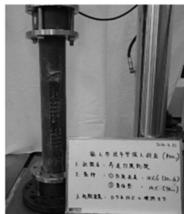
図3 掘上管の高速引張試験結果
