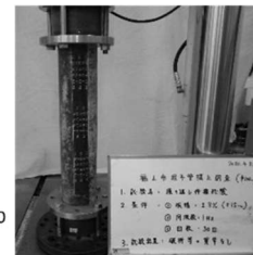
図4 掘上管の繰返し伸縮試験結果
