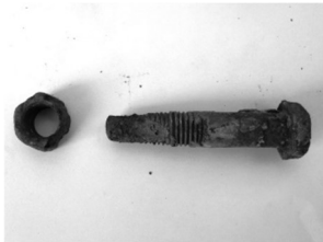
写真1 腐食した金属ボルト
