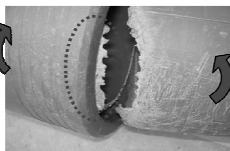
写真 8 回収した破断部 矢印は曲げ方向
