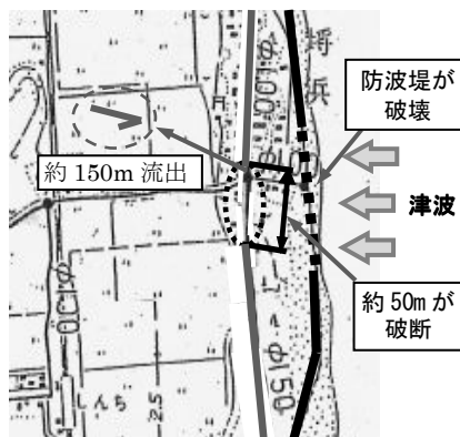
図 1 新地町埠浜付近の被害
