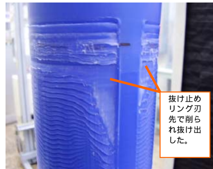
写真 3 インナーコア無しによる管表面
