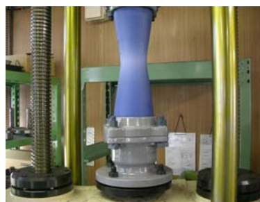
写真1 引抜阻止性能試験状況
